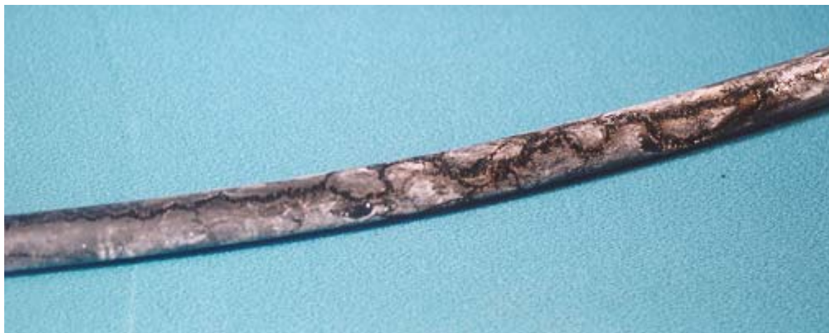
Слика 4.2.12 Квар на изолацији СИП због нерегулисаног електричног поља изван структуре СИП
